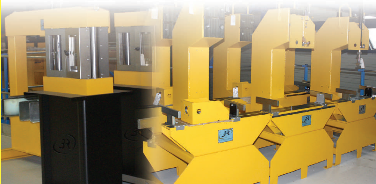
1993 1 re Pupitre Guantris avec presse pour pavés 200kN
