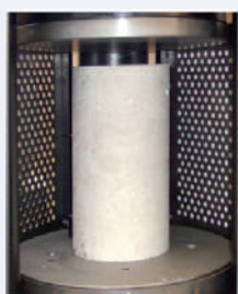
Essais de compression sur cylindres 15 x 30 & 16 x 32
