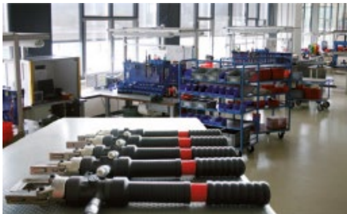
Assemblage des outils hydrauliques au siège
