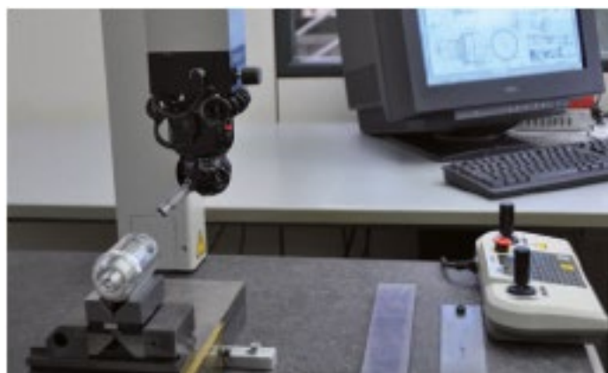
Inspection d'une centrale hydraulique par un dispositif tridimensionnel
